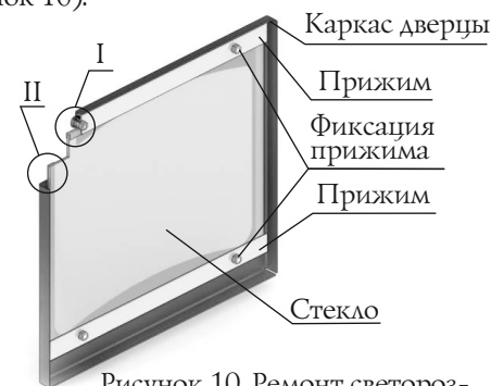
Рисунок 10. Ремонт светопрозрачного экрана дверцы.
